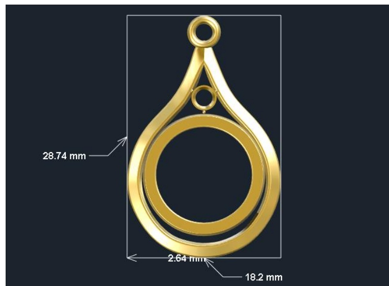
Gambar 4- 1 Detail ukuran desain liontin tampak depan
