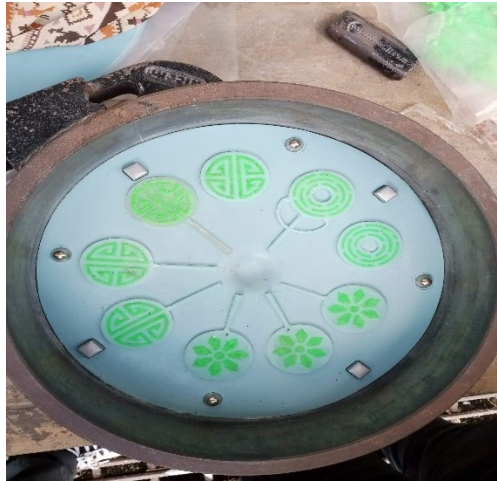
Gambar 3. 21 Posisi master pada silicone rubber
