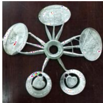
Gambar 2. 1 Hasil pengecoran suhu tinggi
