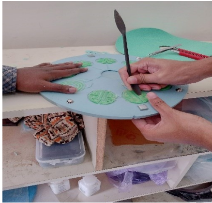
Gambar 4. 9 Proses Penyongkelan Master
