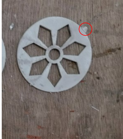
Gambar 4. 40 Sisa Gate Setelah Pemotongan
