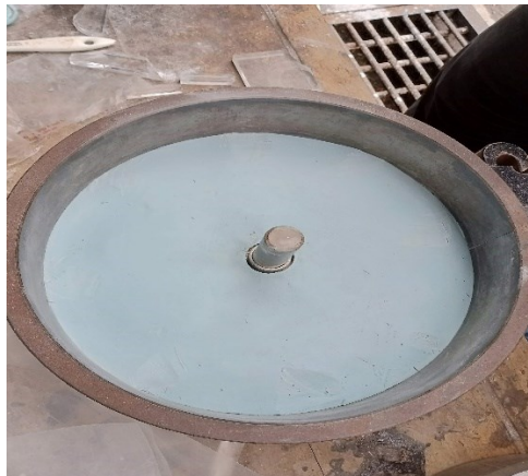
Gambar 3. 22 Pemasangan silicone rubber bagian atas
