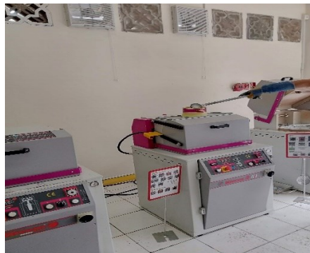
Gambar 3. 25 Proses penuangan logam zinc ke mesin spin casting
