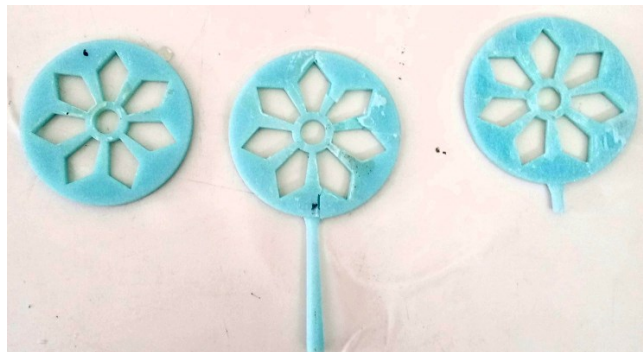
Gambar 4. 10 Kondisi Master setelah Vulkanisir
