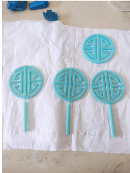
Gambar 4- 2 Runner, Gate dan Master Setelah Finishing
