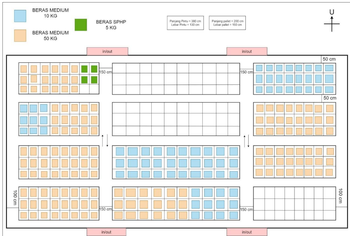
Gambar 4. 1 Kondisi Layout Awalan Gudang A BULOG Kebumen
