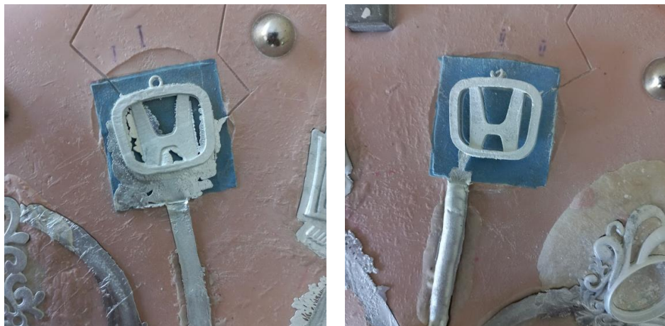
Gambar 4-23 Hasil produk pada lubang I (kiri) dan II (kanan)
