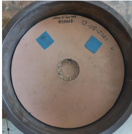
Gambar 4-20 Silicone rubber mold bekas pada molding frame
