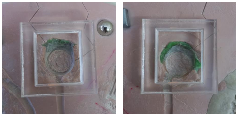
Gambar 4-5 Fitting frame akrilik pada lubang yang akan digunakan
