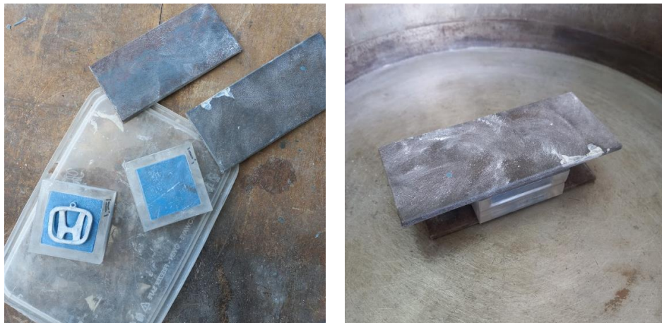
Gambar 4-15 Plat besi, frame akrilik, rubber tambalan, dan master sebelum vulkanisir
