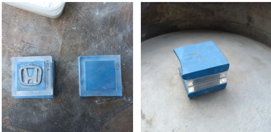
Gambar 4-17 Lapisan silicone rubber , frame akrilik, rubber tambalan, dan master sebelum vulkanisir
