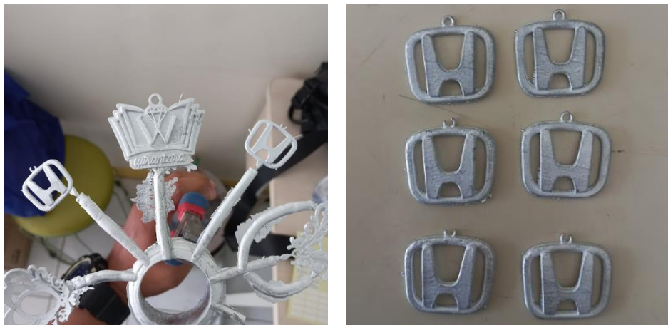
Gambar 4-31 Hasil percobaan spin casting ketiga (kiri) dan keseluruhan produk hasil percobaan (kanan)
