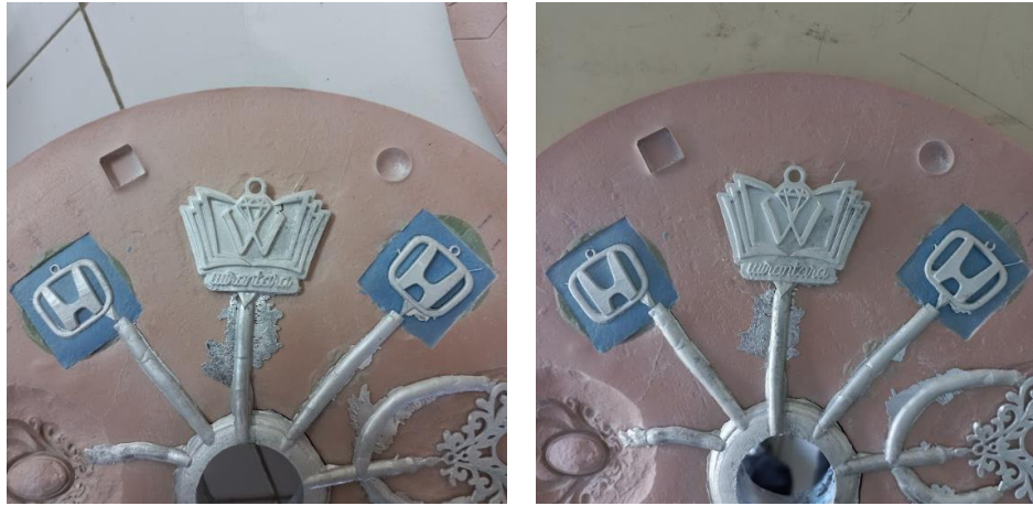
Gambar 4-30 Hasil percobaan spin casting pertama (kiri) dan kedua (kanan)
