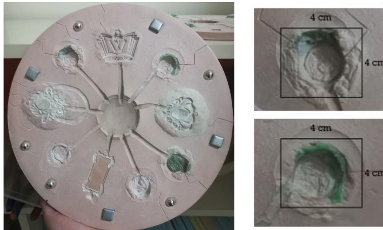
Gambar 4-1 Silicone Rubber Mold bekas (kiri) dan bagian yang akan digunakan untuk penelitian (kanan)
