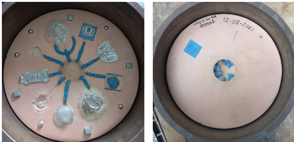
Gambar 4-9 Silicone rubber mold sebelum masuk mesin vulkanisir (kiri) dan Setelah vulkanisir (kanan) untuk lubang I
