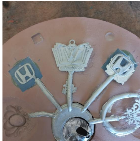
Gambar 4-24 Zinc alloy meluap pada cetakan lubang I
