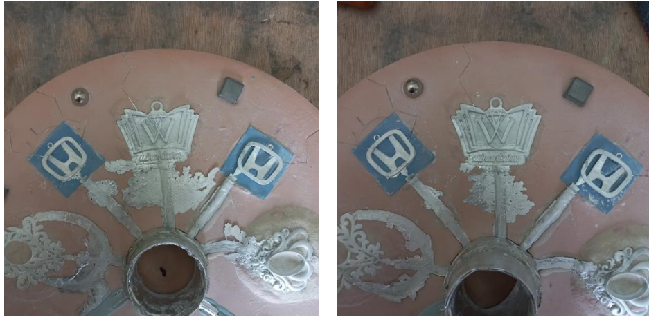
Gambar 4-28 Hasil percobaan spin casting pertama (kiri) dan kedua (kanan)
