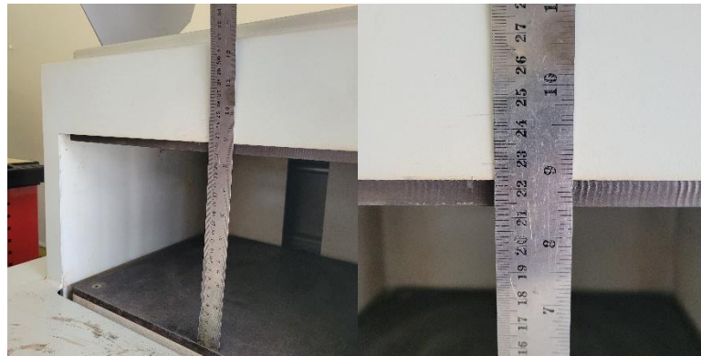
Gambar 4-1 Tinggi maksimal ruang mesin vulkanisir
