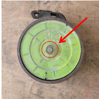
Gambar 4-16 Besi penahan setelah ditambah akrilik
