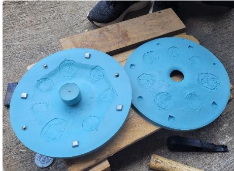
Gambar 4-14 Kecacatan rubber mold
