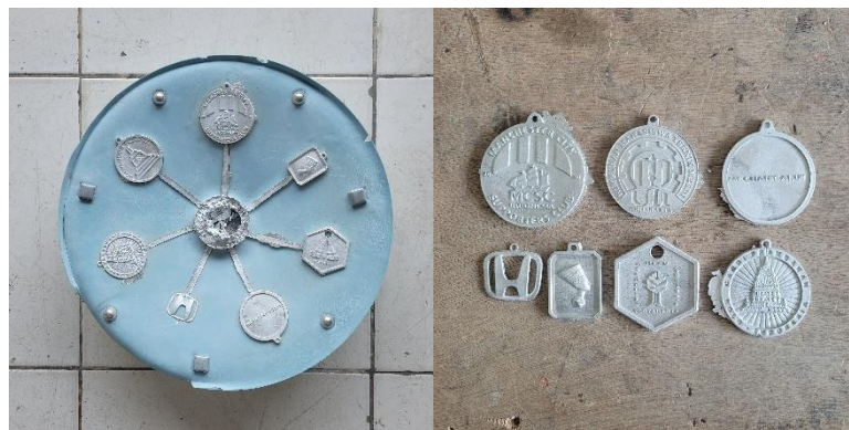
Gambar 4-27 Spesimen hasil spin casting
