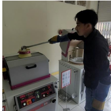
Gambar 4-26 Proses penuangan zinc alloy
