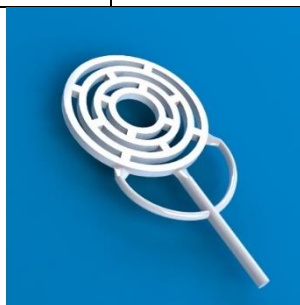
Gambar 4- 2 Desain Master menyatu dengan Runner dan Gate 3 cabang
