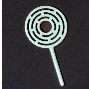
Gambar 4- 5 Master produk menyatu dengan Runner dan Gate dari hasil proses 3D Print resin
