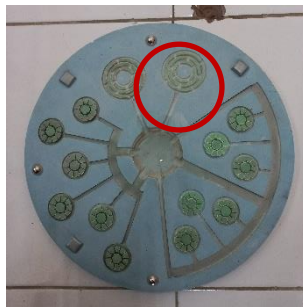
Gambar 4- 17 cetakan yang telah dibuatkan runner
