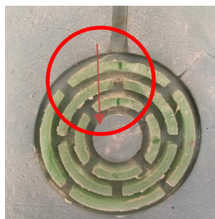
Gambar 4- 31 Penambahan bridge pada cetakan
