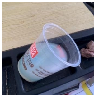
Gambar 4- 7 Perendaman master dengan cairan aseton
