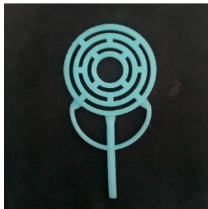
Gambar 4- 6 Master produk menyatu dengan Runner dan Gate 3 cabang dari hasil proses 3D Print resin
