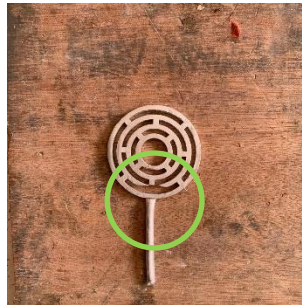
Gambar 4- 30 Cetakan tidak terisi material dengan merata
