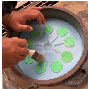
Gambar 4- 10 Pengolesan tacl pada silicone rubber
