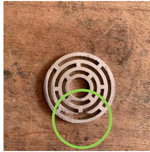
Gambar 4- 29 Cetakan tidak terisi material dengan merata
