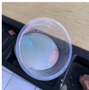
Gambar 4- 8 Perendaman master dengan cairan aseton
