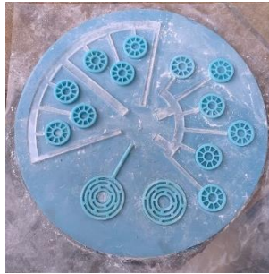
Gambar 4- 9 Pengolesan tacl pada silicone rubber
