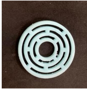
Gambar 4- 4 Master produk dari hasil 3D Print resin
