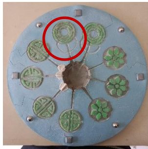
Gambar 4- 16 cetakan yang telah dibuatkan runner
