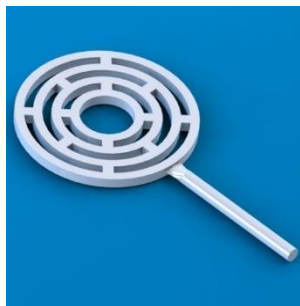
Gambar 4- 1 Desain Master menyatu dengan Runner dan Gate
