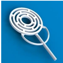
Gambar 3- 16 Desain Master menyatu dengan Runner dan Gate tiga cabang
