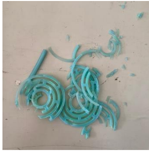
Gambar 4- 15 kondisi master hasil 3D print resin setelah dipisah dari rubber
