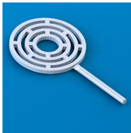
Gambar 3- 15 Desain Master menyatu dengan Runner dan Gate
