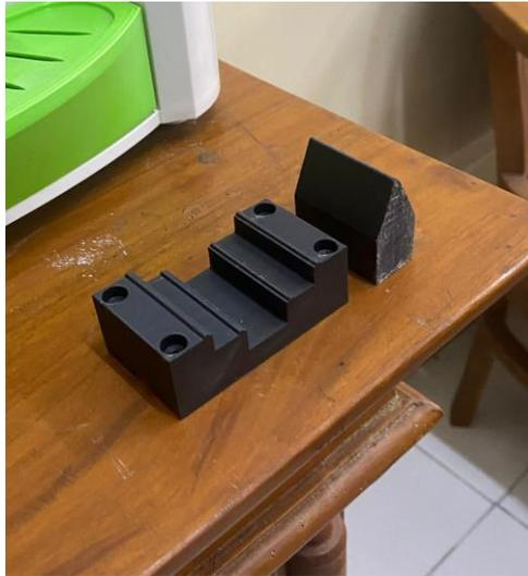
Gambar 3 - 9 Prototipe *Loading Nose* dan *Support*
