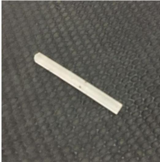
Gambar 3 - 15 Spesimen Uji Hasil 3D *Printing* Resin
