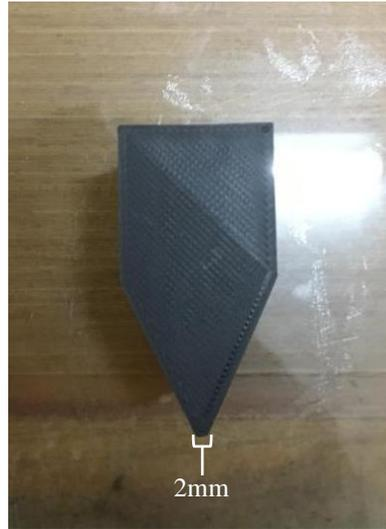
Gambar 3 - 11 Pengukuran Dimensi Komponen *Loading Nose* hasil Prototipe
