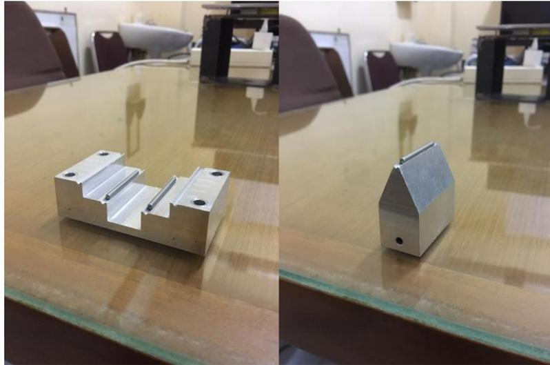
Gambar 4 - 10 Komponen *Support* dan *Loading Nose* dengan Material Aluminium 5052
