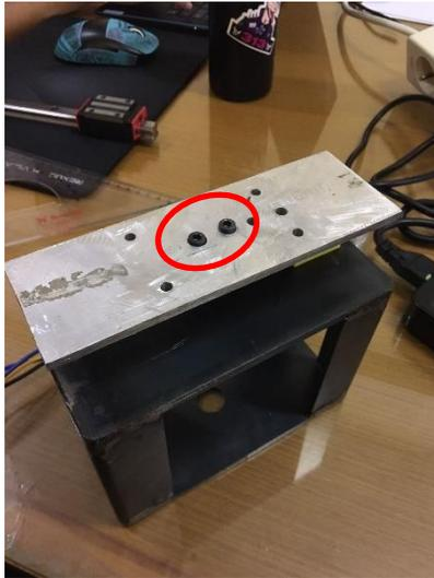
Gambar 4 - 2 Pemasangan Plat Dudukan Pada Sensor Beban
