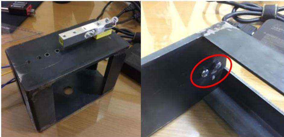
Gambar 4 - 1 Pemasangan Sensor Beban pada Meja Peninggi
