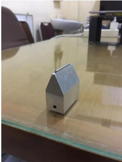
Gambar 3 - 12 Komponen *Loading Nose* Hasil CNC
