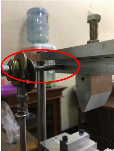
Gambar 4 - 9 Penghubungan Baut Sensor Jarak dengan Dudukan Sensor
