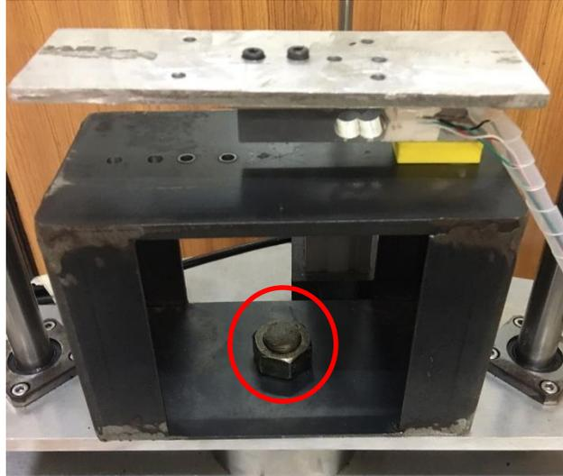
Gambar 4 - 4 Pemasangan Meja Peninggi ke Mesin Uji Lentur
