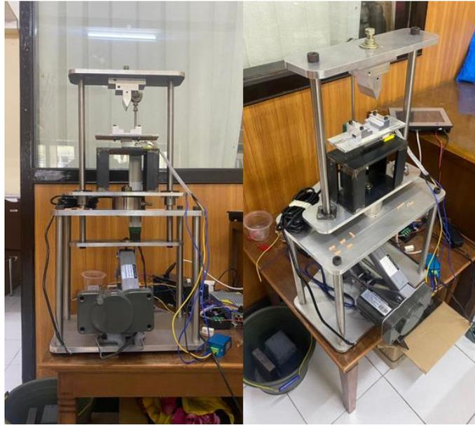
Gambar 4 - 15 Tampilan Depan dan Tampilan Isometrik Mesin Uji Lentur Skala Kecil
