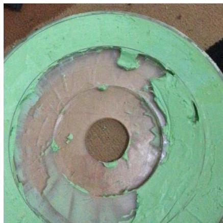
Gambar 4- 4 Proses Pendempulan Alat Penyudut
