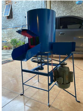
Gambar 4-16 perubahan motor listrik dan dudukan motor listrik.
