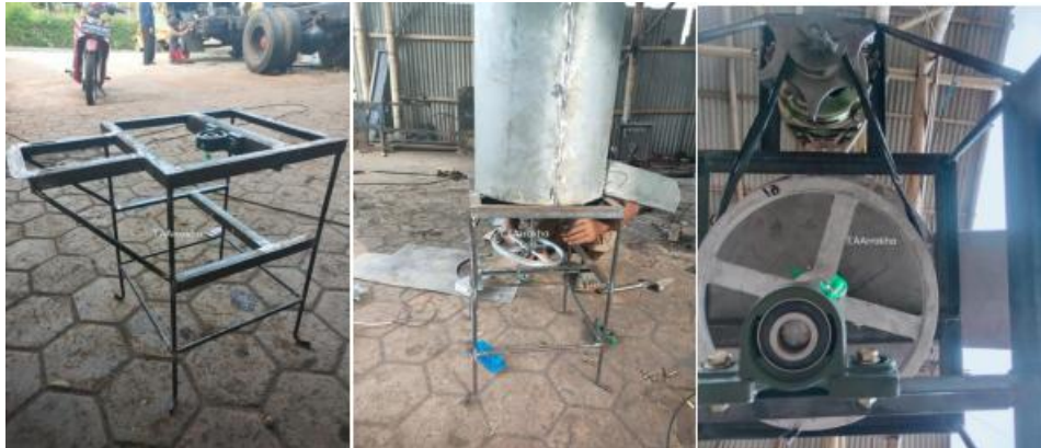
Gambar 4-14 proses merangkai penggerak mesin
