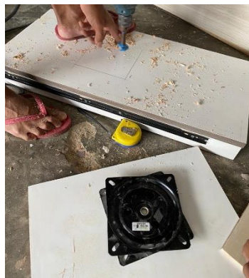
Gambar 4- 26 Proses Pemasangan Lazy susan
