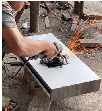
Gambar 4- 22 Proses penghalusan lazy susan dengan plat besi dan long drat
