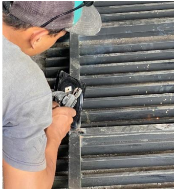
Gambar 4- 21 Proses pengelasan lazy susan dengan plat besi dan long drat
