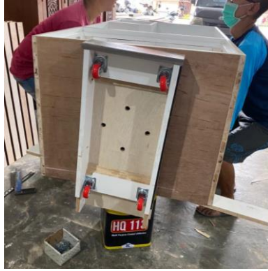
Gambar 4- 25 Proses Pemasangan roda
