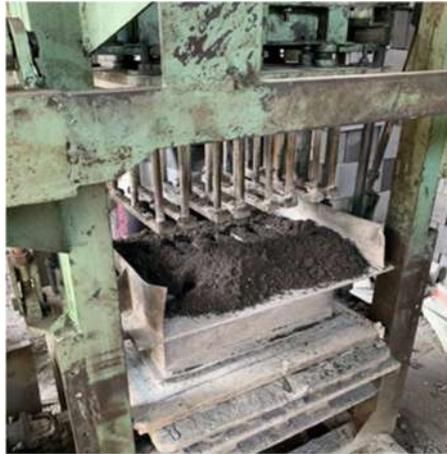
**Gambar 4.3 Proses Pencetakan Batako**
