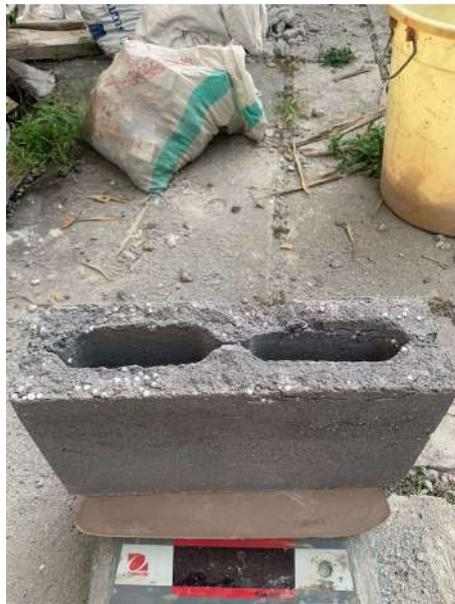
**Gambar L-8.1 Batako Kondisi Kering Oven Ditimbang**
