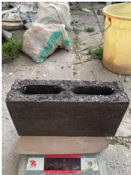
**Gambar L-8.1 Batako Kondisi Basah Ditimbang**
