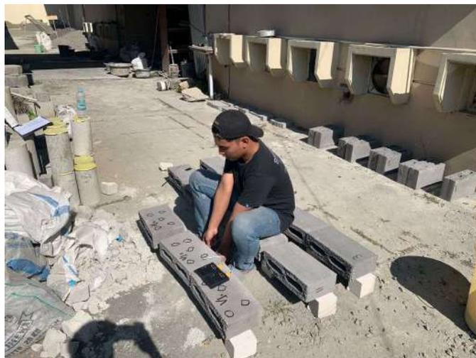
**Gambar L-9.2 Pengukuran Suhu Pada Batako**
