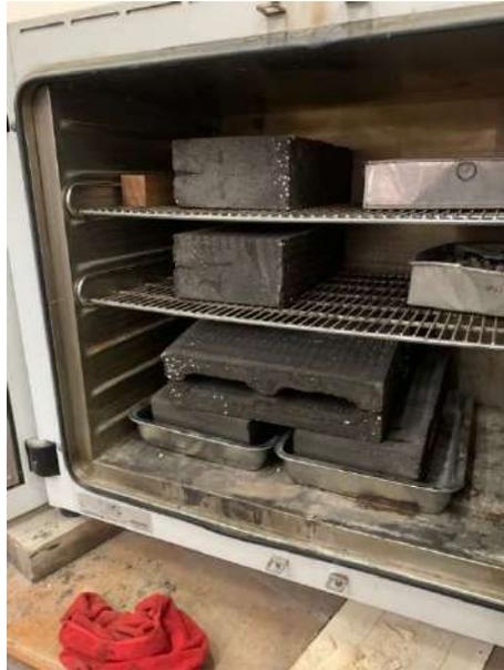
**Gambar L-8.1 Batako Kondisi Basah Dalam Oven**
