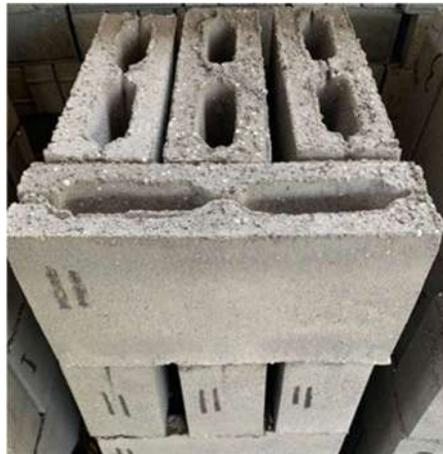
**Gambar 5.16 Batako Variasi II 15% *Styrofoam***
