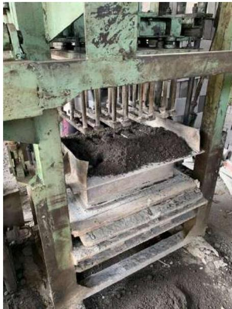
**Gambar L-6.2 Proses Pencetakan Batako**
