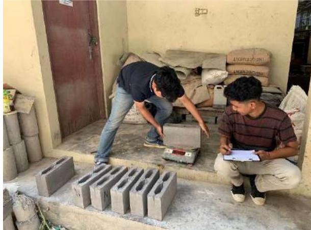
**Gambar 4.6 Pengukuran dan Penimbangan Batako**
