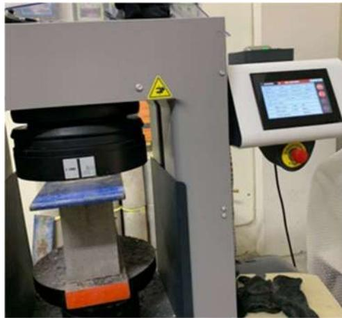
**Gambar 4.7 Posisi Benda Uji Batako Saat Uji Kuat Tekan**
