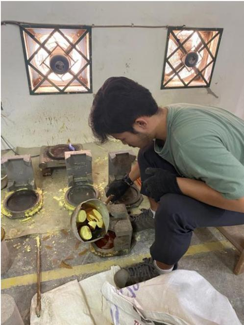
Proses Capping Permukaan Beton Sebelum Uji Kuat Tekan
