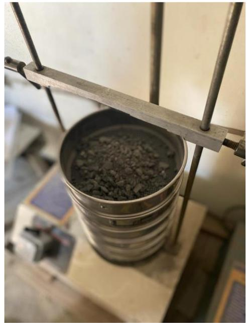
Proses Menghaluskan Pecahan Hasil Uji Kuat Tekan Untuk Pengujian Uji SEM
