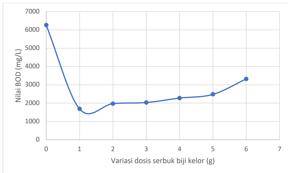
Gambar 4. 3 Hasil uji BOD dengan variasi dosis koagulan
