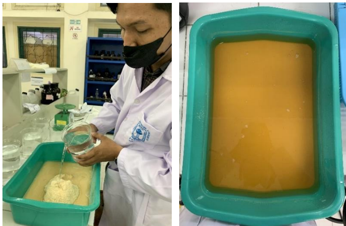
Gambar 4. 10. (a) Perendaman Adsorben Menggunakan Asam Sitrat dan (b) Hasil Perendaman Adsorben Selama 1 x 24 Jam
