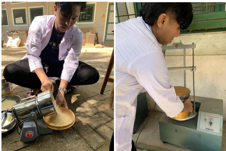
Gambar 4. 5. (a) Proses Penghancuran Menggunakan Blender dan (b) Proses Ayakan Sumpit Menjadi Powder dengan Ukuran Ayakan 100 Mesh
