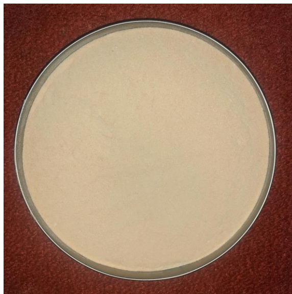
Gambar 4. 8. Powder Adsorben Sumpit Bekas Tidak Aktivasi Sumber : Dokumentasi Pribadi, 2023
