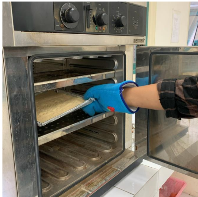
Gambar 4. 12. Proses Pengeringan Adsorben Menggunakan Oven Sumber : Dokumentasi Pribadi, 2023
