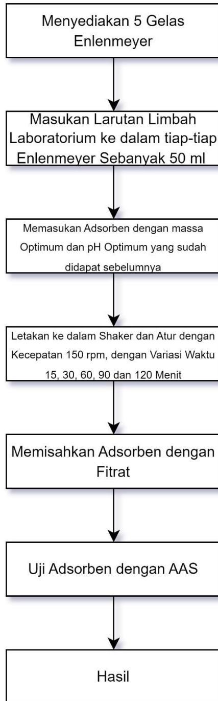
Gambar 3. 6. Diagram Alir Menentukan Waktu Kontak Optimum Sumber : Data Primer, 2023
