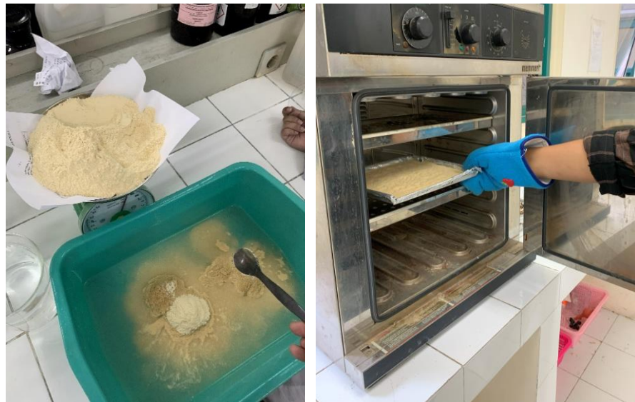
Gambar 4. 7. (a) Proses Pencucian Adsorben Menggunakan Aquades dan (b) Proses Pengeringan Adsorben Menggunakan Oven Sumber : Dokumentasi Pribadi, 2023
