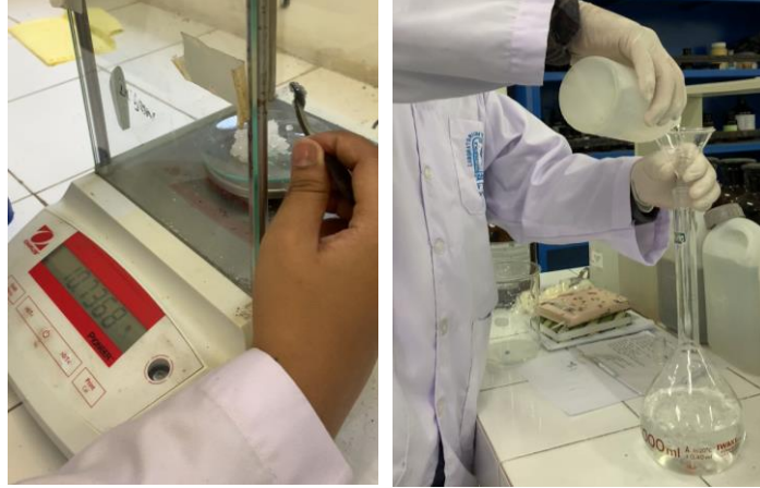
Gambar 4. 9. (a) Proses Meninmbang Asam Sitrat Menggunakan Neraca Analitik dan (b) Proses Penghomogenan Asam Sitrat Menggunakan Labu Ukur 1000 mL
