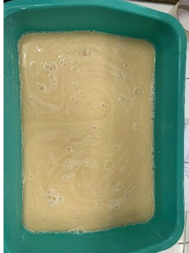
Gambar 4. 11. Proses Pencucian Adsorben Menggunakan Aquades Sumber : Dokumentasi Pribadi, 2023
