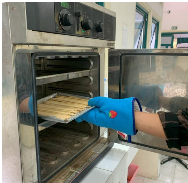
Gambar 4. 4. Proses Pengovenan Sumpit Bekas Pakai Sumber : Dokumentasi Pribadi, 2023
