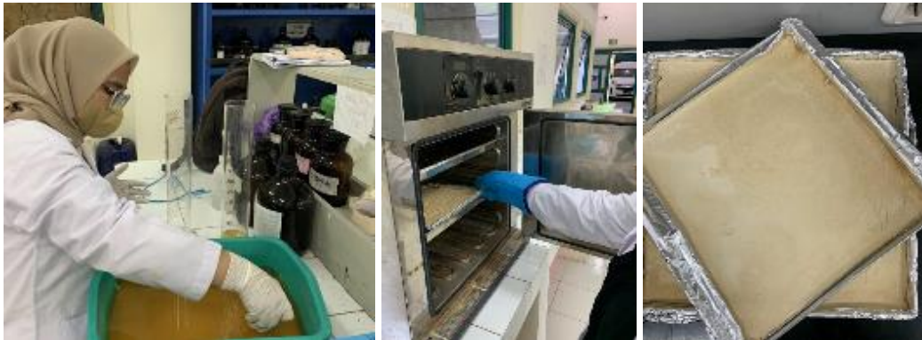
Gambar 4. 12 Proses Aktivasi Dengan C_6H_8O_7 0,4 M (Asam Sitrat)
