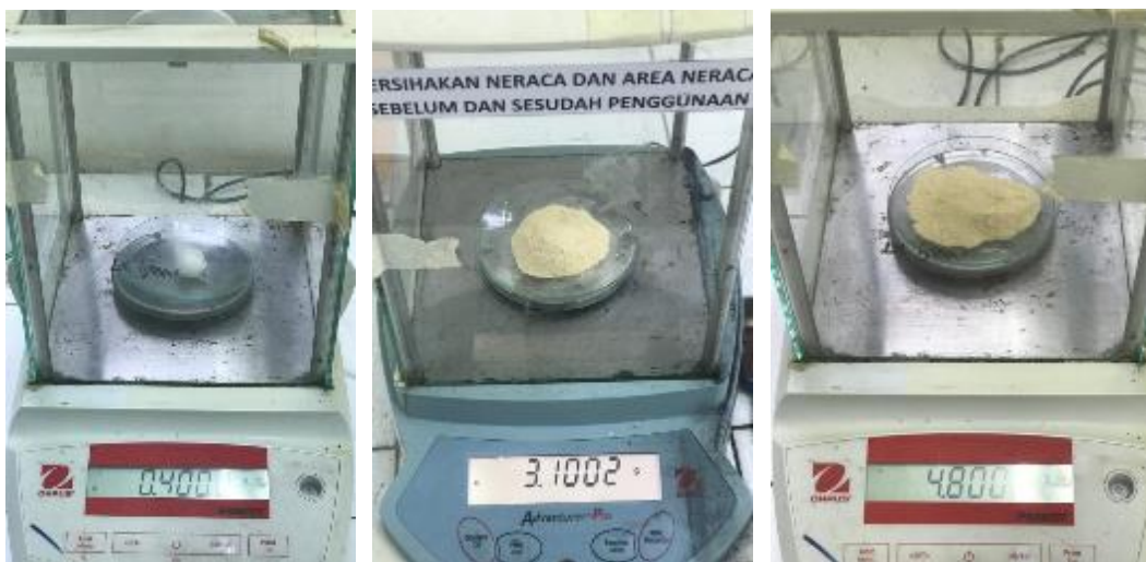
Gambar 4. 14 Proses Penimbangan Glasswool dan Adsorben Sumpit Bekas Sumber: Data Primer, 2023
