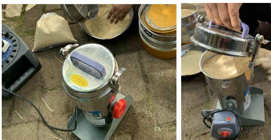
Gambar 4. 6 Proses Penghalusan Sumpit Bekas (Blender) Sumber: Data Primer, 2023
