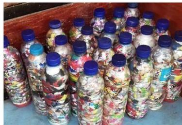
Gambar 4. 10 Contoh sampah plastic yang akan dimasukkan ke dalam botol dan hasil pembuatan *ecobrick*
