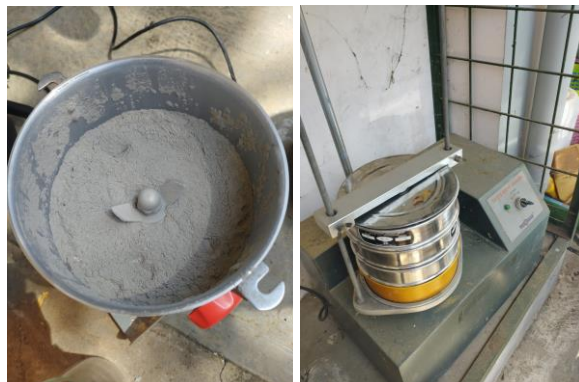
Menghaluskan Batu Apung Menggunakan Grinder Mill (kiri), Mengayak Bubuk Batu Apung Hingga Ukuran 100 Mesh (kanan)
