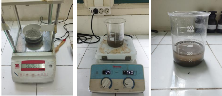
Menimbang Bubuk Batu Apung yang akan diaktivasi (kiri), Mengaduk Bubuk Batu Apung dengan Larutan HCl 1% (tengah), Merendam Bubuk Batu Apung dengan HCl 1% (kanan)
