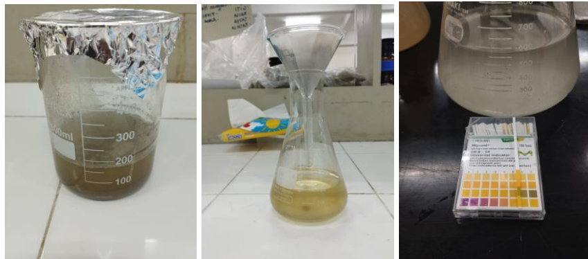
Merendam Bubuk Batu Apung dengan Mn(NO_3)_2 0,5 M (kiri), Menyaring Adsorben (Tengah), Membilas Adsorben Hingga Air Bilasan Memiliki pH Netral (kanan)
