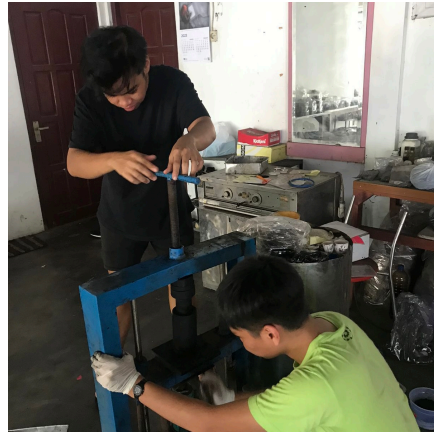
Gambar 5. 6 Proses Pencetakan dan Pengepresan Briket
