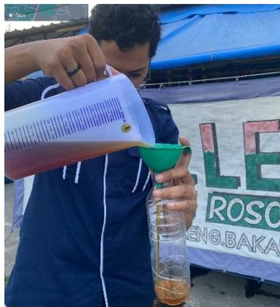
Gambar 3 5 Pengukuran timbulan minyak jelantah menggunakan gelas ukur volume
