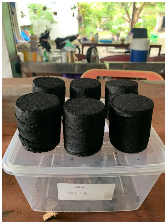
Gambar 18. Briket Sudah Siap Setelah Dipanaskan Menggunakan Oven
