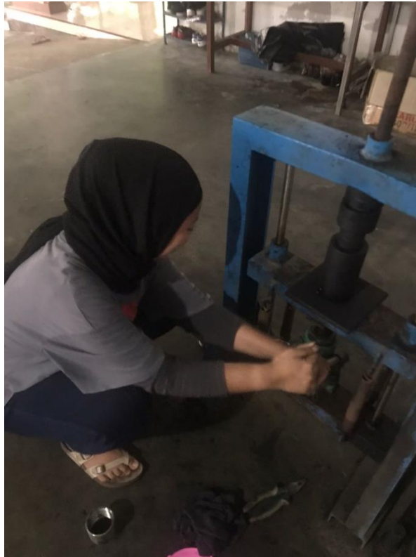
Gambar 17. Mencetak Briket Menggunakan Hydraulic Press
