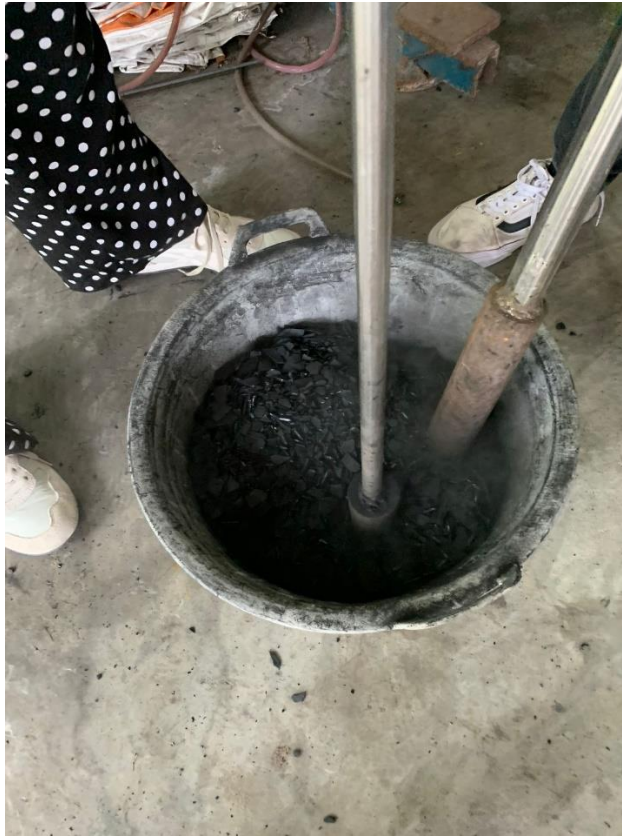
Gambar 11. Penumbukan Biochar Hasil dari Proses Pirolisis
