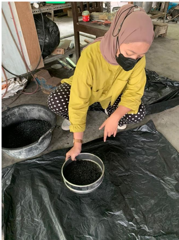
Gambar 12. Penyaringan Arang menggunakan Sieve Shaker 20 mesh
