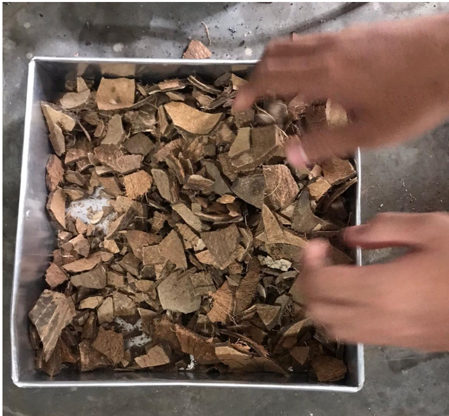
Gambar 8. Memperkecil Ukuran Tempurung Kelapa
