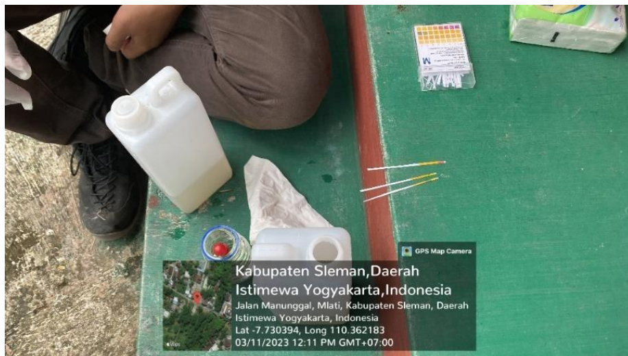
Gambar 5. 12 Proses Pengawetan COD Menggunakan Larutan H 2 SO 4
