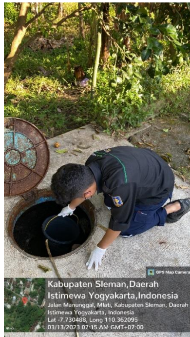
Gambar 4.4 Pengujian Debit Air Limbah Inlet dan Outlet
