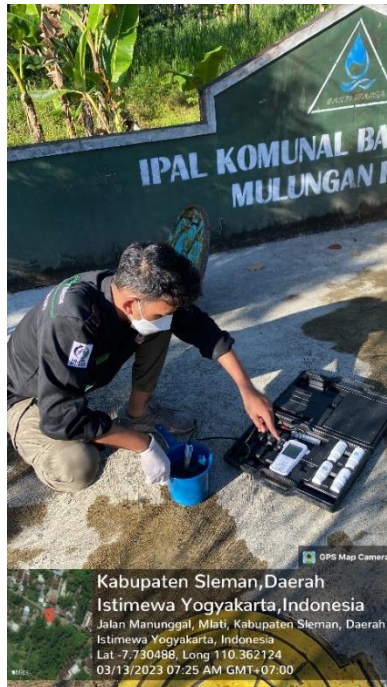
Gambar 5. 14 Proses Pengukuran DHL Terhadap Sampel
