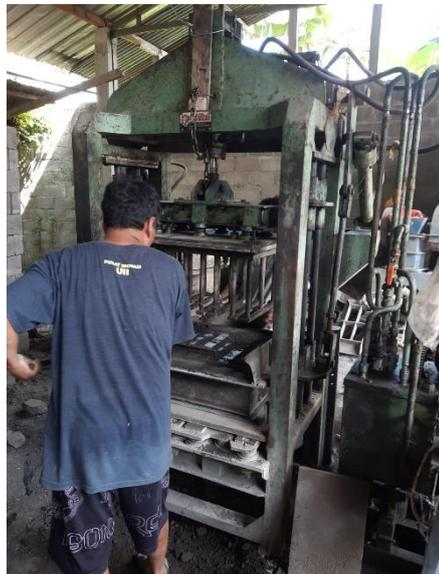
**Gambar 5.12** Proses Cetak Batako menggunakan Mesin Press
