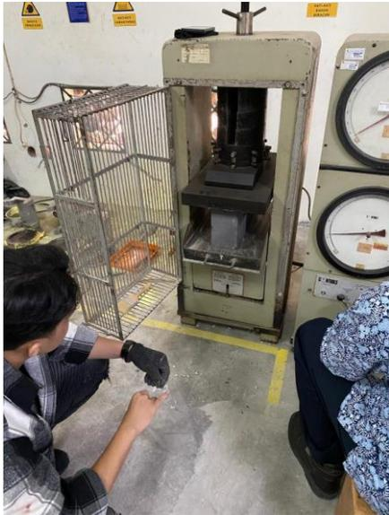
**Gambar 5.19** Pengujian Kuat Tekan Batako *Fly ash*
