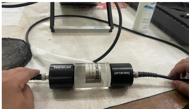
Gambar 4.17 Kalibrasi Alat Pengujian UPV
