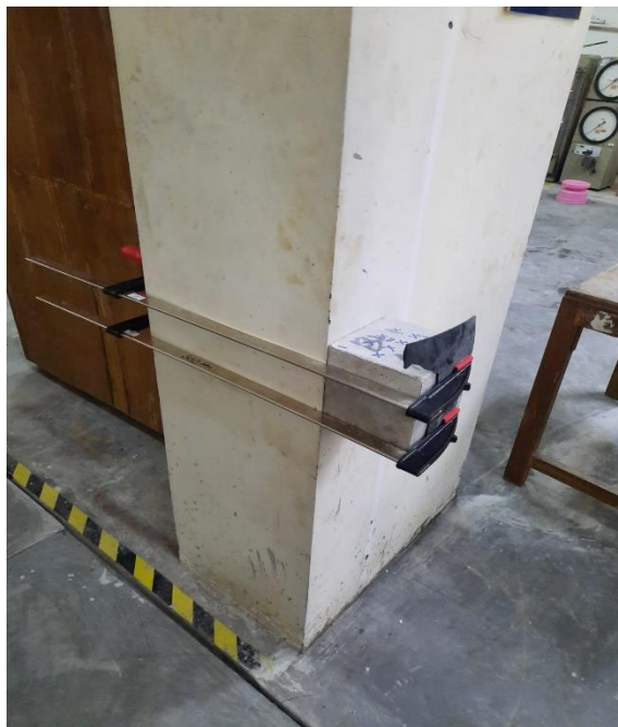
Gambar L-5.4 Penjepitan Benda Uji Menggunakan Clamp F
