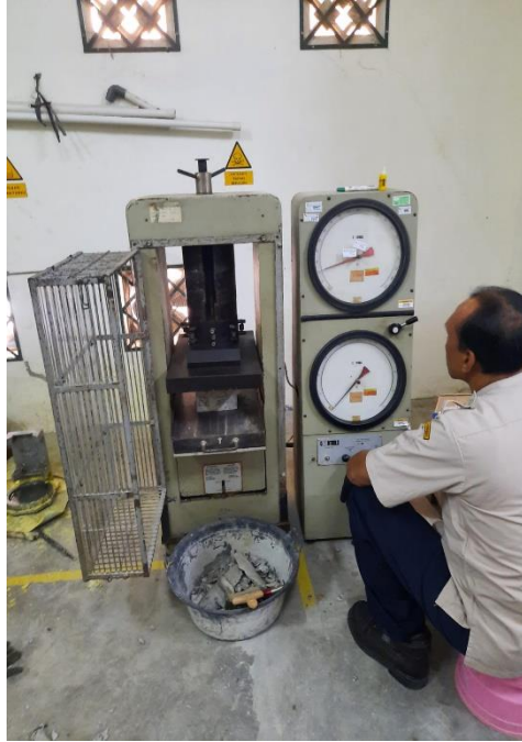
Gambar L-5.5 Pengujian Kuat Tekan Beton
