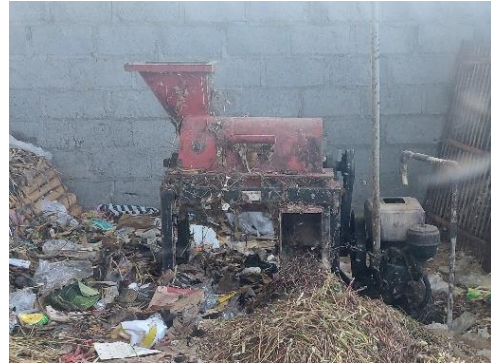
Gambar 2. Mesin Pencacahan Organik Srihardono Bersih
