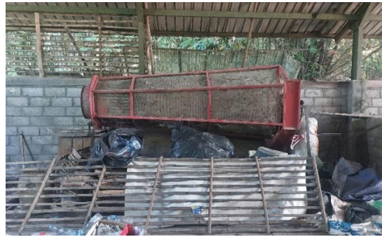
Gambar 11. Mesin Pengayakan TPS 3R Tirtoasri
