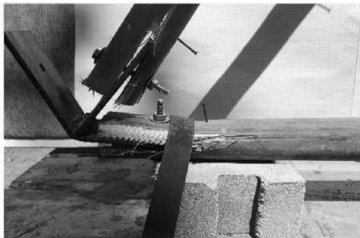
Gambar 7 Deformasi Sambungan B Sumber : Dokumentasi Penulis 2022
