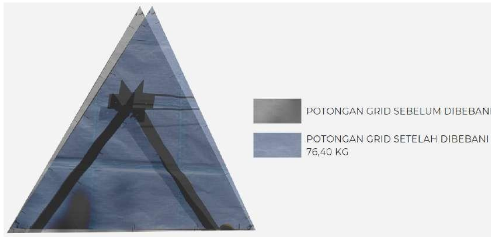
Gambar 6 Perbandingan Potongan Grid Sebelum dan Sesudah Pembebanan Sumber : Dokumentasi Penulis 2022
