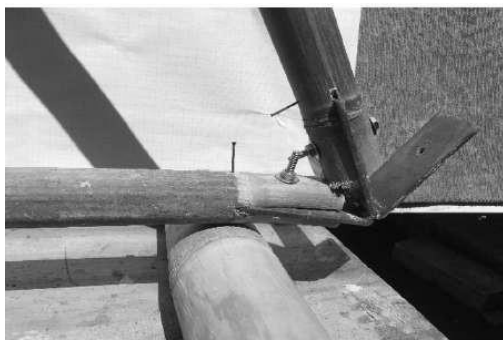
Gambar 8 Deformasi Sambungan C Sumber : Dokumentasi Penulis 2022
