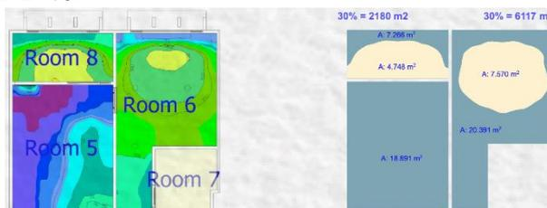
**Gambar 10** Hasil uji *daylighting* unit kamar  $56\text{m}^2$  menggunakan Dialux
