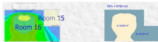
**Gambar 8** Hasil uji *daylighting* unit kamar  $28\text{m}^2$  menggunakan Dialux
