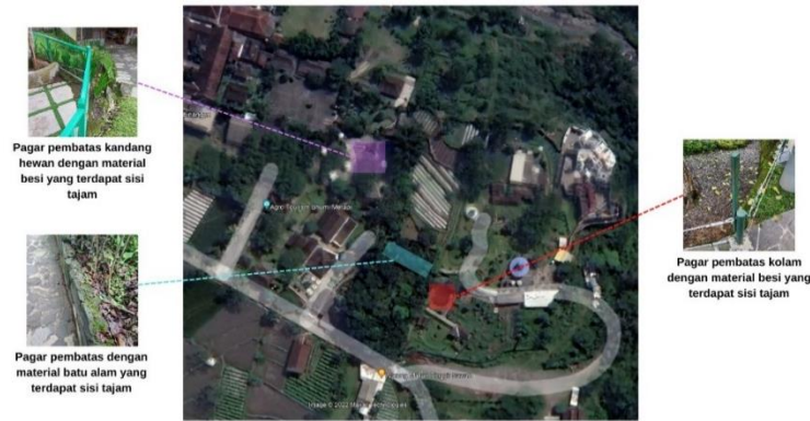
Gambar 21 Tonjolan Konstruksi pada Pagar Pembatas di TBM Sumber: Dokumentasi Pribadi, 2022
