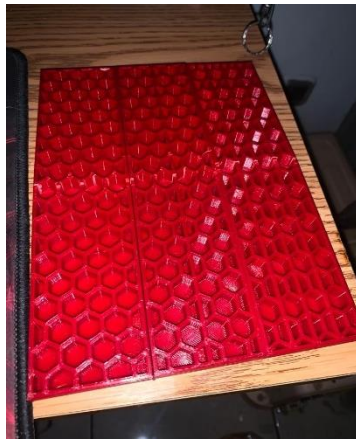
Gambar 3-38 Spesimen tanpa skin carbon fiber
