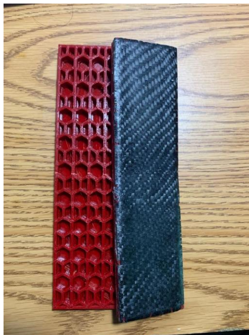
Gambar 4-3 Hasil pengujian dengan skin carbon fiber
