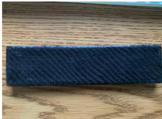
Gambar 3-39 Spesimen dengan skin carbon fiber
