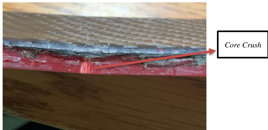
Gambar 4-7 Spesimen 3 horizontal ribs dengan skin
