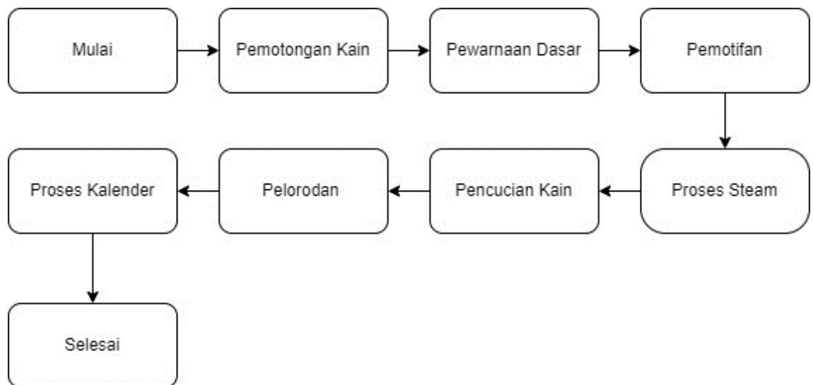
Gambar 4. 1 Diagram Proses Produksi
