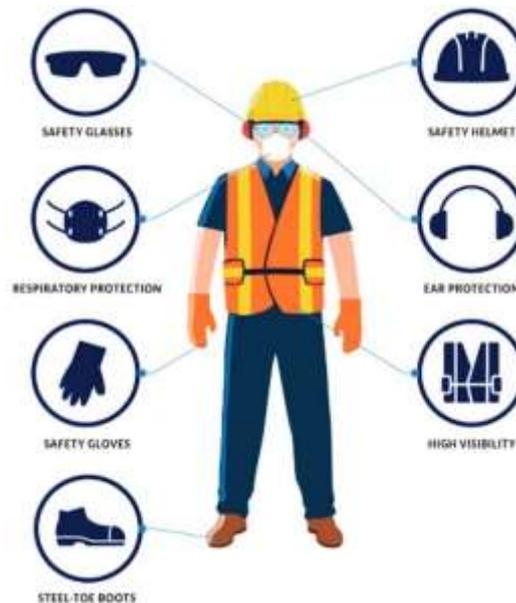
Gambar 5.7 Contoh Usulan Perbaikan *Safety*
