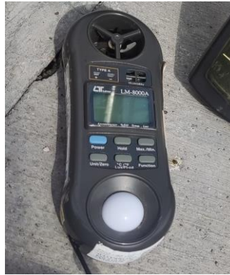
Gambar 3.5 Anemometer alat ukur kecepatan angin dan arah angin
