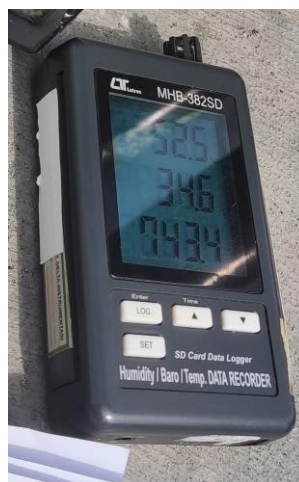
Gambar 3.4 Thermohygrometer alat ukur suhu, kelembaban dan tekanan udara
