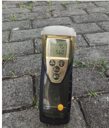
Gambar 3.3 Testo 315-3 alat ukur konsentrasi CO dan CO 2
