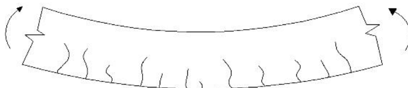
Gambar 3.16 Pola Retak Lentur Balok
