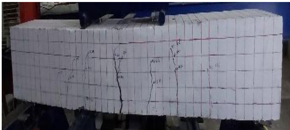
Gambar 5.22 Kerusakan Sampel Uji Balok Coupler Zaneta (2022) (Sumber: Zaneta (2022))
