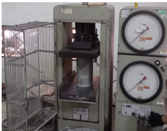
Gambar 5.10 Pengujian Kuat Tekan Silinder
