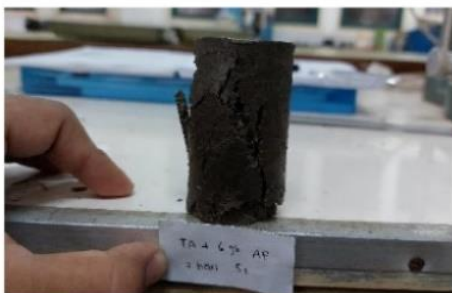
Hasil Pengujian Kuat Tekan Bebas Tanah Asli + 6% Asam Fosfat ( H_3PO_4 ) Pemeraman 7 Hari Sampel 1
