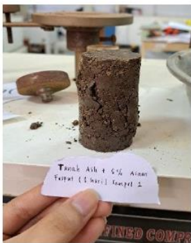
Hasil Pengujian Kuat Tekan Bebas Tanah Asli + 6% Asam Fosfat ( H_3PO_4 ) Pemeraman 1 Hari Sampel 2
