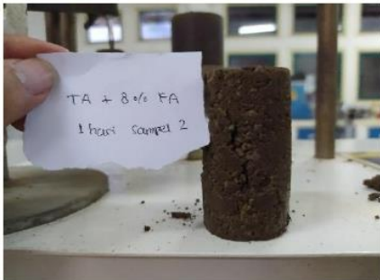
Hasil Pengujian Kuat Tekan Bebas Tanah Asli + 8% Fly Ash Pemeraman 1 Hari Sampel 2
