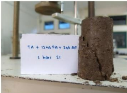
Hasil Pengujian Kuat Tekan Bebas Tanah Asli + 12% Fly Ash + 2% Asam Fosfat ( H_3PO_4 ) Pemeraman 1 Hari Sampel 1
