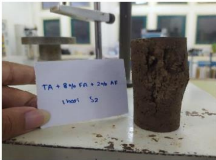
Hasil Pengujian Kuat Tekan Bebas Tanah Asli + 8% Fly Ash + 2% Asam Fosfat ( H_3PO_4 ) Pemeraman 1 Hari Sampel 2
