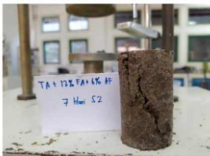
Hasil Pengujian Kuat Tekan Bebas Tanah Asli + 12% Fly Ash + 6% Asam Fosfat ( H_3PO_4 ) Pemeraman 1 Hari Sampel 2
