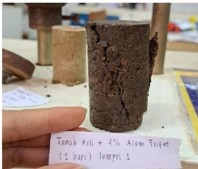
Hasil Pengujian Kuat Tekan Bebas Tanah Asli + 4% Asam Fosfat ( H_3PO_4 ) Pemeraman 1 Hari Sampel 1
