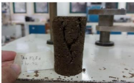
Hasil Pengujian Kuat Tekan Bebas Tanah Asli + 8% Fly Ash Pemeraman 7 Hari Sampel 2
