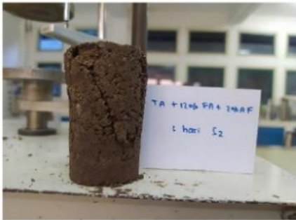
Hasil Pengujian Kuat Tekan Bebas Tanah Asli + 12% Fly Ash + 2% Asam Fosfat ( H_3PO_4 ) Pemeraman 1 Hari Sampel 2
