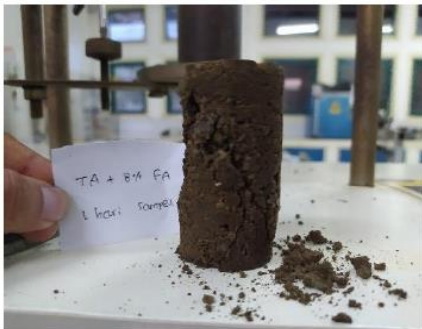
Hasil Pengujian Kuat Tekan Bebas Tanah Asli + 8% Fly Ash Pemeraman 1 Hari Sampel 1
