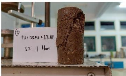
Hasil Pengujian Kuat Tekan Bebas Tanah Asli + 12% Fly Ash + 6% Asam Fosfat ( H_3PO_4 ) Pemeraman 1 Hari Sampel 2
