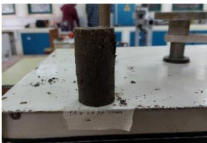
Hasil Pengujian Kuat Tekan Bebas Tanah Asli + 2% Asam Fosfat ( H_3PO_4 ) Pemeraman 7 Hari Sampel 2
