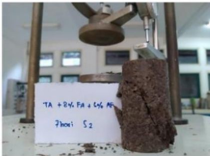
Hasil Pengujian Kuat Tekan Bebas Tanah Asli + 8% Fly Ash + 6% Asam Fosfat ( H_3PO_4 ) Pemeraman 1 Hari Sampel 2
