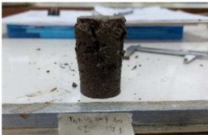
Hasil Pengujian Kuat Tekan Bebas Tanah Asli + 4% Asam Fosfat ( H_3PO_4 ) Pemeraman 7 Hari Sampel 2
