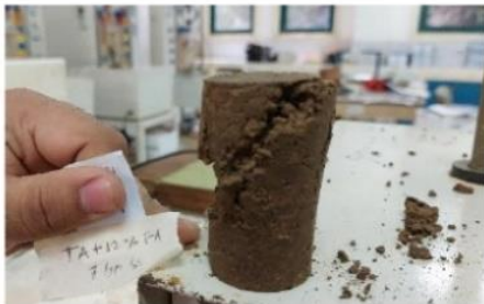
Hasil Pengujian Kuat Tekan Bebas Tanah Asli + 12% Fly Ash Pemeraman 7 Hari Sampel 2
