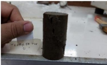
Hasil Pengujian Kuat Tekan Bebas Tanah Asli + 8% Fly Ash Pemeraman 7 Hari Sampel 1
