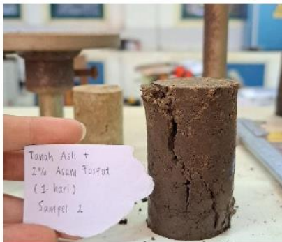
Hasil Pengujian Kuat Tekan Bebas Tanah Asli + 2% Asam Fosfat ( H_3PO_4 ) Pemeraman 1 Hari Sampel 2
