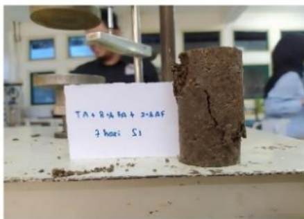
Hasil Pengujian Kuat Tekan Bebas Tanah Asli + 8% Fly Ash + 2% Asam Fosfat ( H_3PO_4 ) Pemeraman 7 Hari Sampel 1
