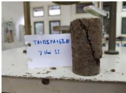
Hasil Pengujian Kuat Tekan Bebas Tanah Asli + 12% Fly Ash + 6% Asam Fosfat ( H_3PO_4 ) Pemeraman 1 Hari Sampel 1
