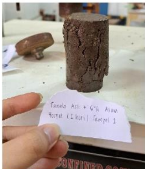
Hasil Pengujian Kuat Tekan Bebas Tanah Asli + 6% Asam Fosfat ( H_3PO_4 ) Pemeraman 1 Hari Sampel 1
