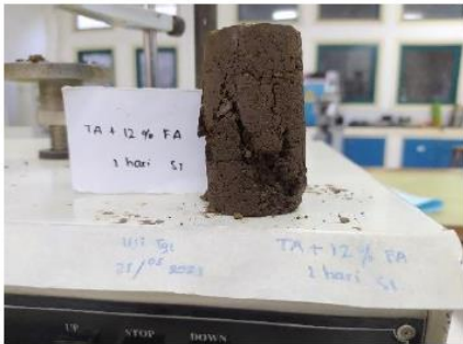
Hasil Pengujian Kuat Tekan Bebas Tanah Asli + 12% Fly Ash Pemeraman 1 Hari Sampel 1
