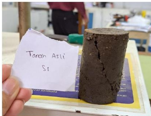
Hasil Pengujian Kuat Tekan Bebas Pada Tanah Asli Sampel 1
