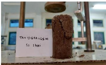
Hasil Pengujian Kuat Tekan Bebas Tanah Asli + 12% Fly Ash + 6% Asam Fosfat ( H_3PO_4 ) Pemeraman 1 Hari Sampel 1
