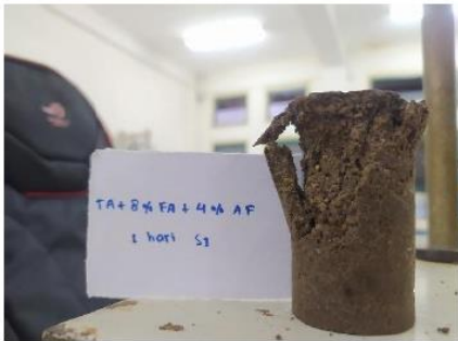
Hasil Pengujian Kuat Tekan Bebas Tanah Asli + 8% Fly Ash + 4% Asam Fosfat ( H_3PO_4 ) Pemeraman 1 Hari Sampel 1
