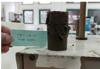
Hasil Pengujian Kuat Tekan Bebas Tanah Asli + 2% Asam Fosfat ( H_3PO_4 ) Pemeraman 7 Hari Sampel 1
