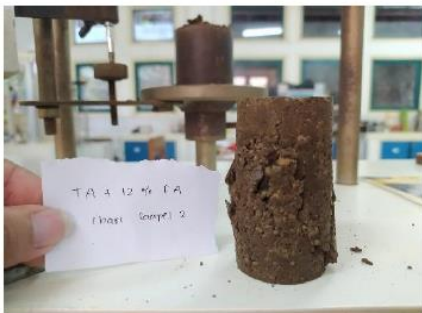
Hasil Pengujian Kuat Tekan Bebas Tanah Asli + 12% Fly Ash Pemeraman 1 Hari Sampel 2
