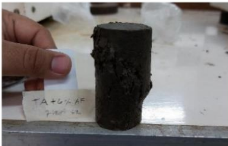
Hasil Pengujian Kuat Tekan Bebas Tanah Asli + 6% Asam Fosfat ( H_3PO_4 ) Pemeraman 7 Hari Sampel 2
