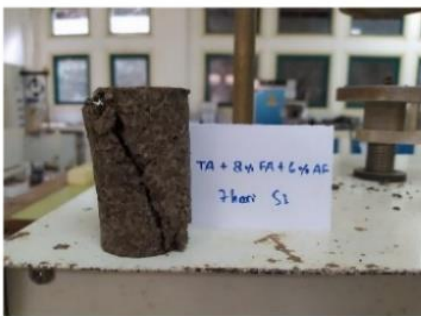
Hasil Pengujian Kuat Tekan Bebas Tanah Asli + 8% Fly Ash + 6% Asam Fosfat ( H_3PO_4 ) Pemeraman 1 Hari Sampel 1
