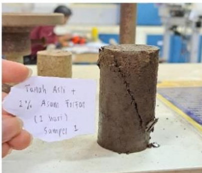
Hasil Pengujian Kuat Tekan Bebas Tanah Asli + 2% Asam Fosfat ( H_3PO_4 ) Pemeraman 1 Hari Sampel 1
