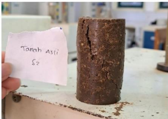
Hasil Pengujian Kuat Tekan Bebas Pada Tanah Asli Sampel 2
