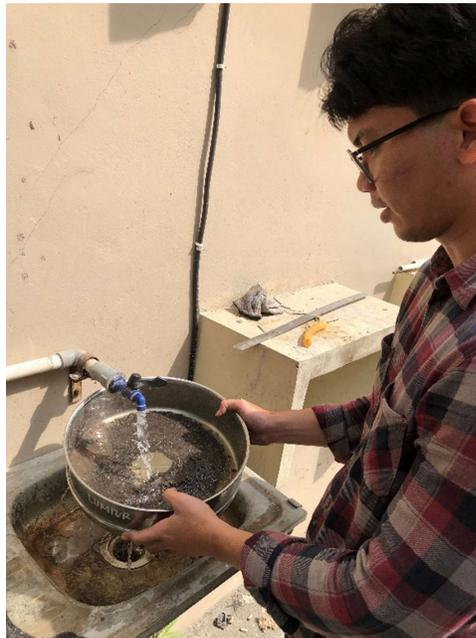
**Gambar L-2.4 Pengujian Kadar Lumpur**
