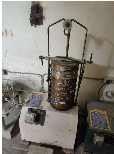
**Gambar L-2.2 Pengguncangan Pasir dengan Shaker**
