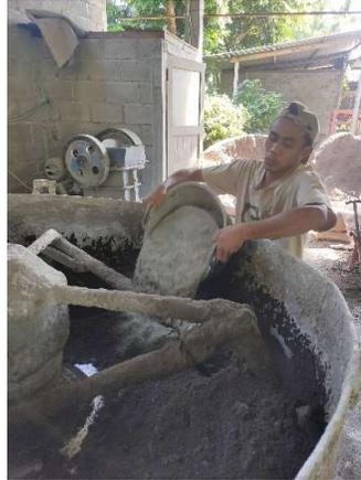
**Gambar 4.14 Memasukkan Bahan Penyusun ke *Mixer Machine***
