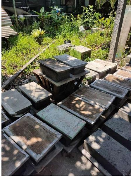
**Gambar L-1.1 Benda Uji Setelah di Cetak**
