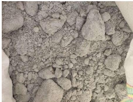
**Gambar 4.4 Limbah Karbit dari PT. Industri Gas Alam Murni Sejahtera**
