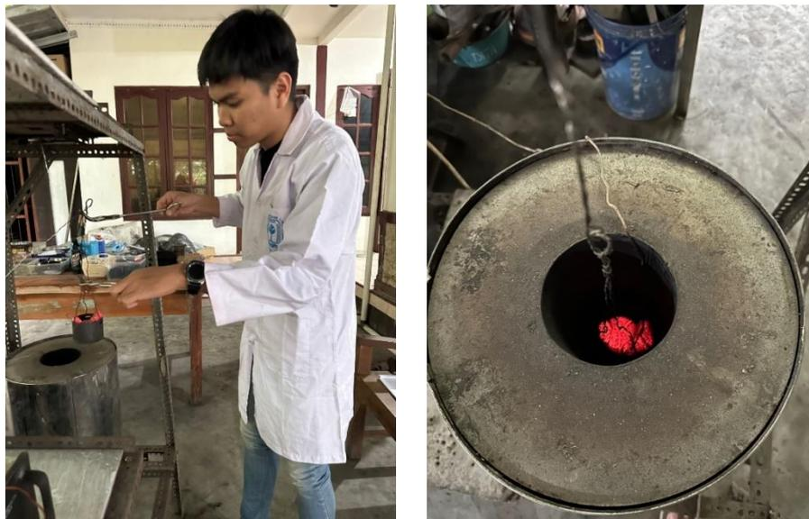
**Gambar 5.17** Pengujian Laju Pembakaran Briket
