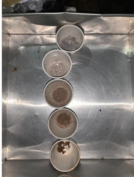
**Gambar 5.16** Pengujian Kadar Air, Kadar *Volatile Matter*, dan Kadar Abu Briket
