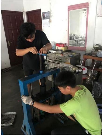
**Gambar 5.9** Pencetakan dan Pengepresan Briket
