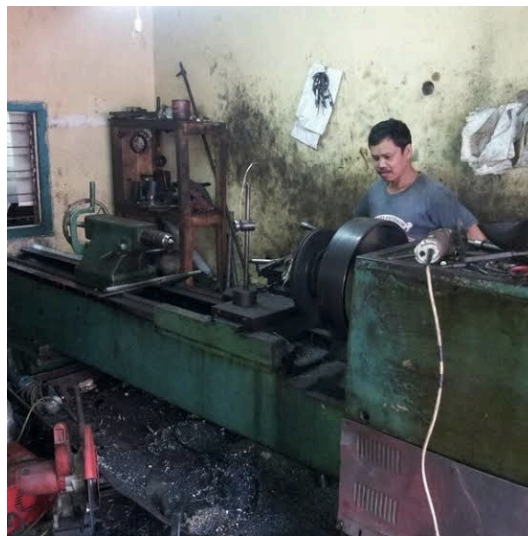
Gambar 4. 14 Pemasangan besi coran ke mesin bubut
