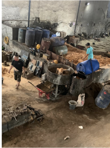
Gambar 4. 1 Pencampuran tanah dengan semen
