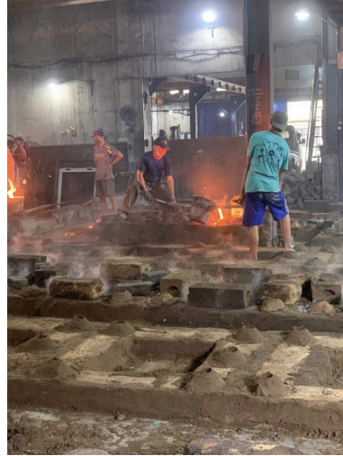
Gambar 4. 9 Menuangkan cairan ke dalam cetakan
