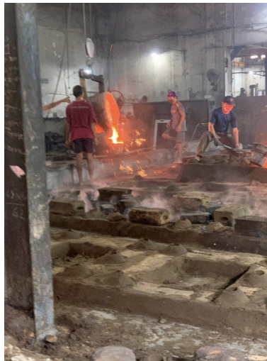
Gambar 4. 8 Mengangkat tungku oven dengan crane
