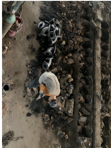
Gambar 4. 10 Memisahkan besi coran dari pasir cetakan
