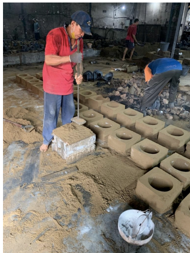
Gambar 4. 2 Penumbukan campuran agar padat
