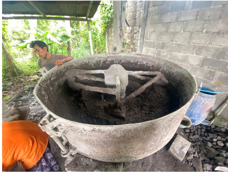
Gambar L-2. 3 Pencampuran Bahan Penyusun Batako
