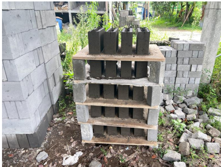
Gambar L-2. 6 Proses Penumpukan Batako Setelah Dicetak
