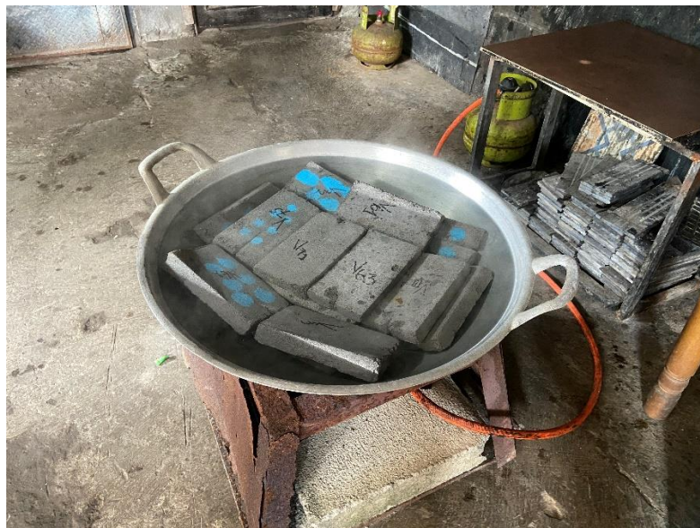
Gambar L-3. 4 Proses Perebusan Batako Pengujian Rongga dalam Batako
