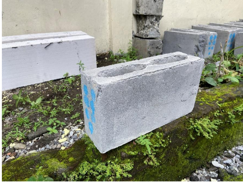
Gambar L-4. 3 Benda Uji Hasil Kuat Tekan
