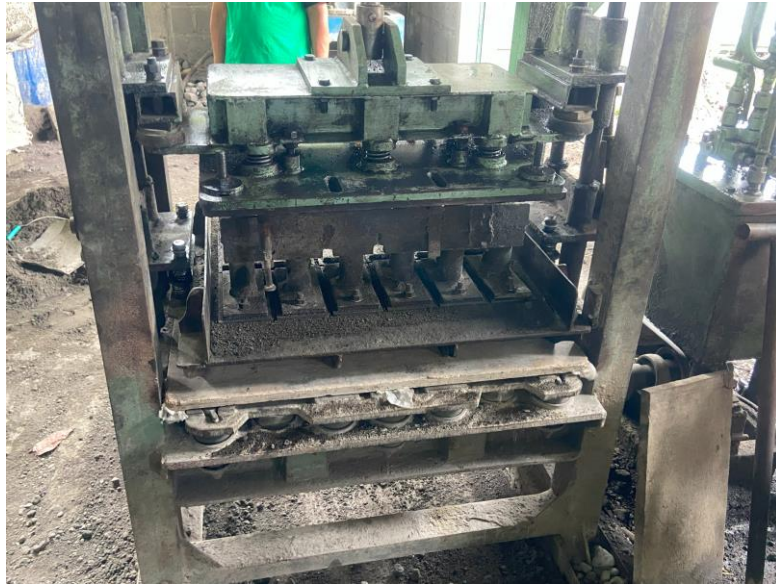
Gambar L-2. 5 Proses Press Batako
