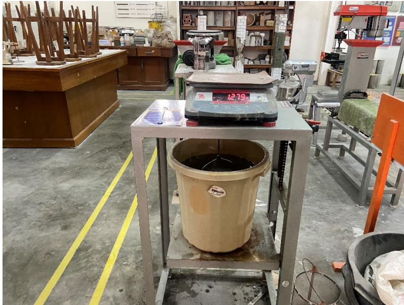
Gambar L-3. 5 Penimbangan Semu untuk Uji Rongga dalam Batako
