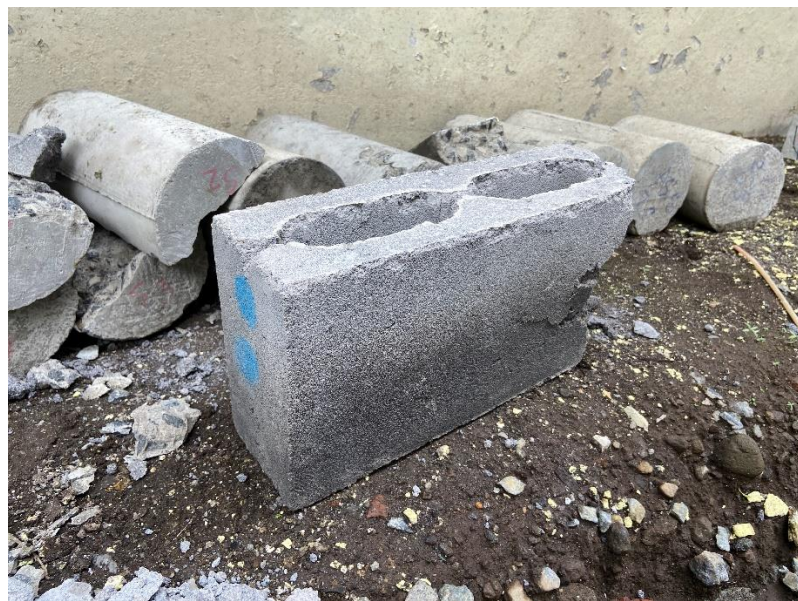
Gambar L-4. 2 Benda Uji Hasil Kuat Tekan
