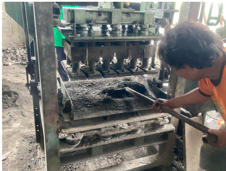
Gambar L-2. 4 Proses Perataan Bahan Penyusun Batako
