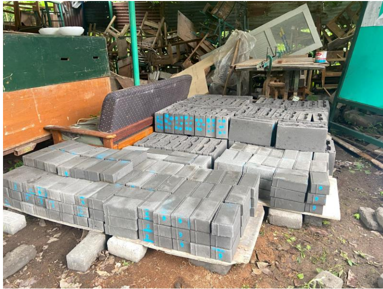
Gambar L-2. 7 Proses Penumpukan Batako Uji Setelah Mengeras
