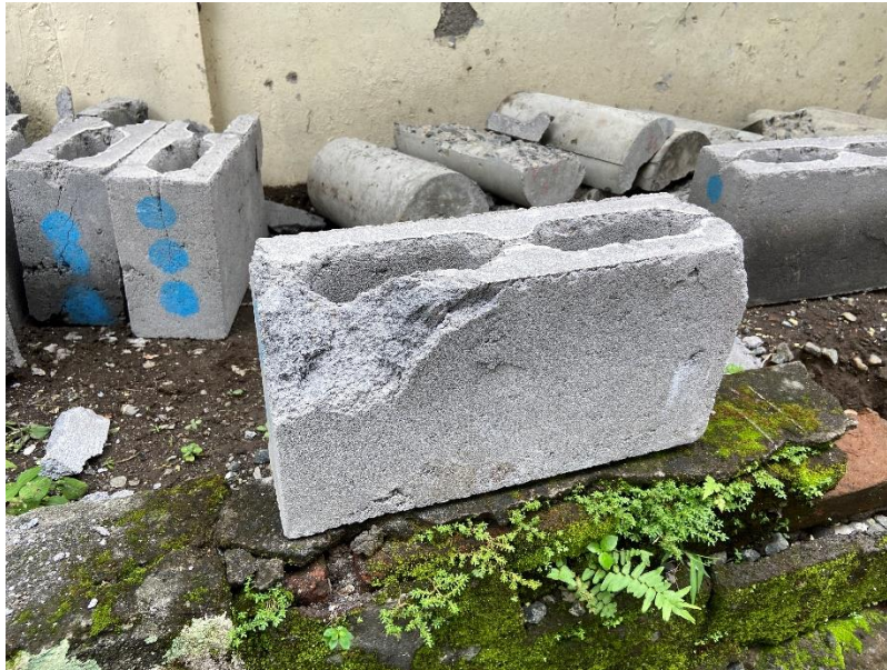
Gambar L-4. 1 Benda Uji Hasil Kuat Tekan
