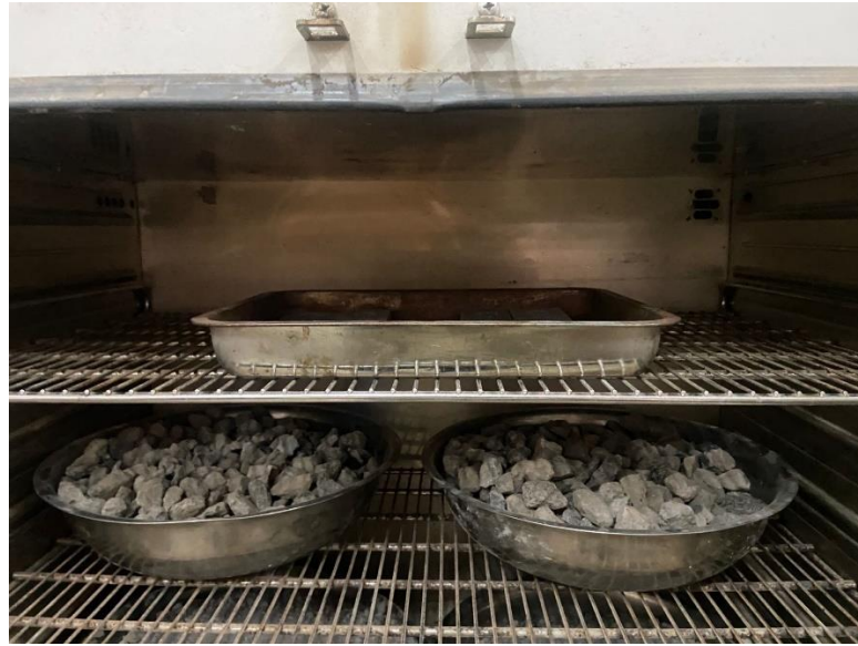
Gambar L-3. 3 Proses Penimbangan Pengujian Penyerapan Air Batako
