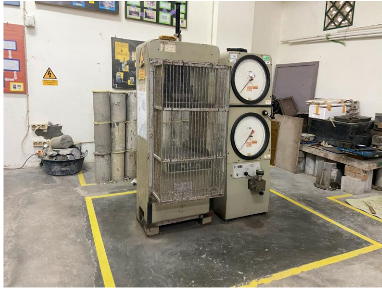
Gambar L-3. 1 Pengujian Kuat Tekan Batako
