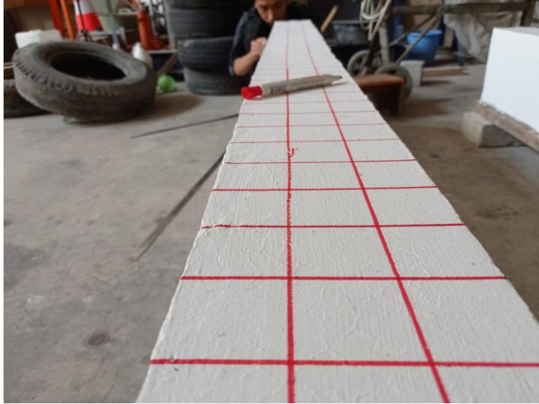
Gambar L-2.9 Proses Pengecatan dan Garis Per 5 cm Pada Balok
