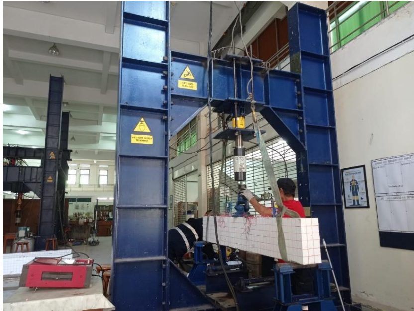
Gambar L-2.11 Proses Pengujian Pembebanan Benda Uji Balok
