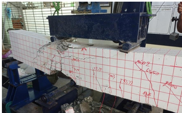
Gambar 5.19 Kondisi Balok Clamp Setelah Pengujian
