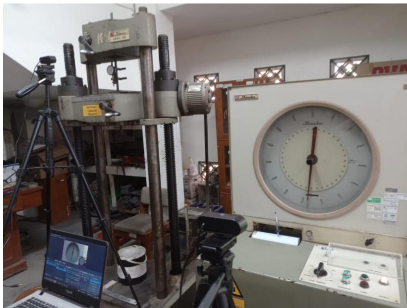
Gambar L-2.2 Pengujian Tarik Tulangan Baja
