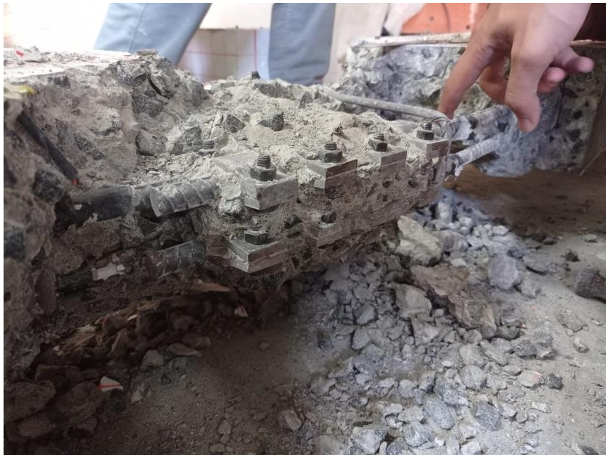
Gambar L-2.14 Proses Pengecekan Tulangan Setelah Pengujian
