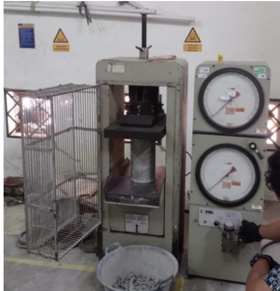
Gambar 5.10 Pengujian Kuat Tekan Silinder Beton
