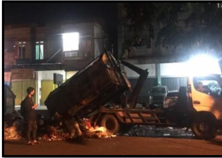
Gambar 4. 16 Proses Menaikkan Kontainer ke Truck Arm Roll
