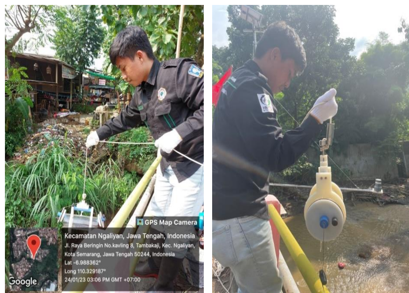
Gambar 3. 2 Pengambilan Sampel Air
