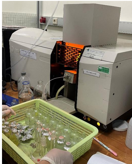
Gambar 3. 6 Pengujian Contoh Uji Menggunakan AAS
