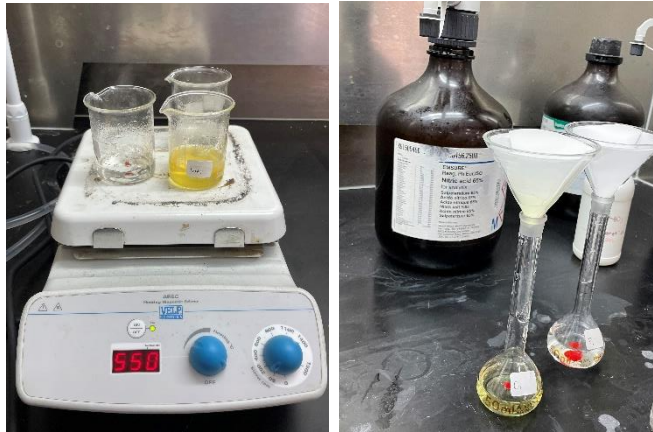
Gambar 3. 5 Destruksi Contoh Uji dan Penyaringan
