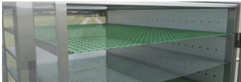
Gambar 3. 3 Lubang-Lubang Kecil Pada Dinding Mesin Pengering
