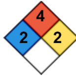
Gambar 2.1 Hazard Diamond Asetaldehid
