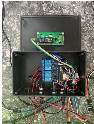
Gambar 4. 12 Tampak Terbuka *Housing* Modul Utama
