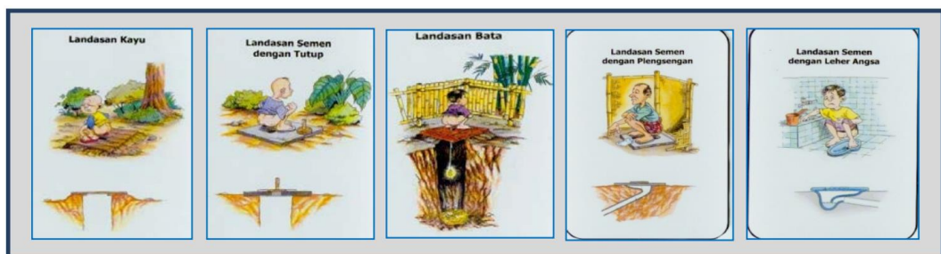
Gambar 2.3. Bangunan Tengah Jamban
