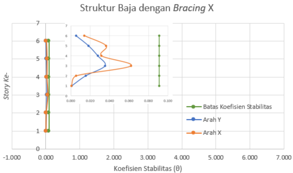
Gambar 5.25 Grafik Koefisien stabilitas Struktur Baja dengan Bracing X
