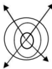
Gambar 3.5 Pola Jaringan Drainase Radial
