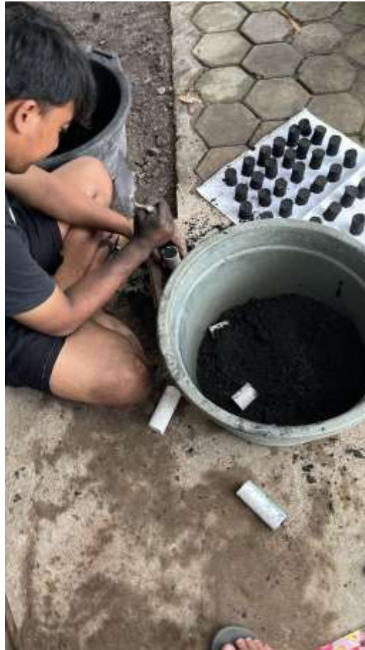
Gambar 2.7 Proses Mencetak Arang Yang sudah Halus
