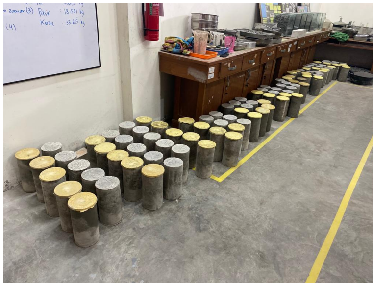
Gambar L8.6 Sampel Beton Sebelum Pengujian
