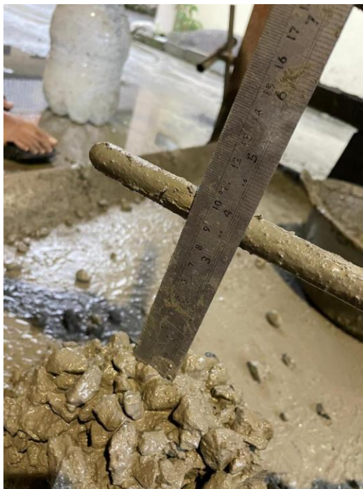
Gambar L8.4 Uji Slump Beton
