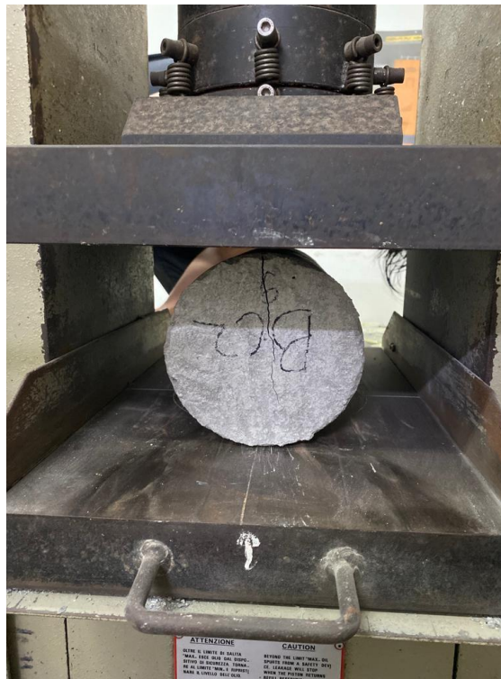
Gambar L8.7 Pengujian Tarik Belah Beton
