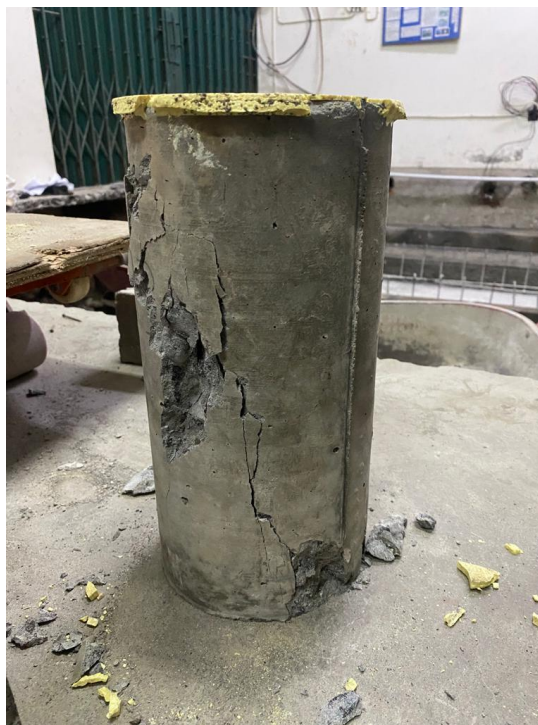
Gambar L8.8 Sampel Beton Setelah Uji Kuat Tekan
